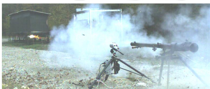
Figura 22- Lovitură cu motor real pe traiect (se observă funcționarea trasoarelor)
