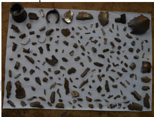
Figura 27 - Schije generate de funcționarea unei componente de luptă
