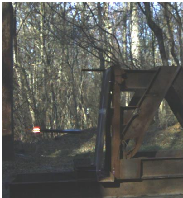
Figura 24- Lovitură cu motor real la țintă (se observă stingerea motorului rachetă, trasorul încă funcționează)
