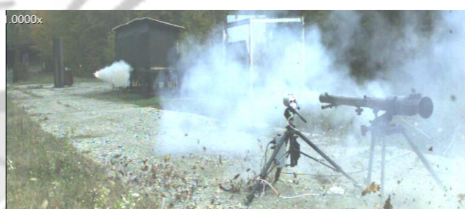
Figura 23- Lovitură cu motor real pe traiect (se observă aprinderea motorului rachetă)
