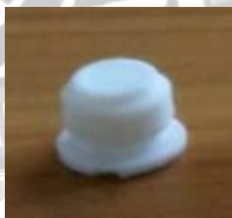
Fig.12 (a), (b) - Prezentarea șurubului portamorsă în diferite etape de dezvoltare
