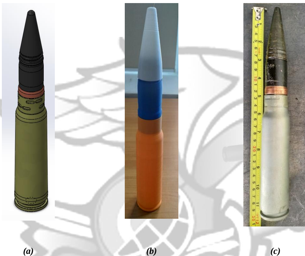
Fig. 13 (a), (b), (c) - Prezentarea muniției asamblate în diferite etape de dezvoltare
