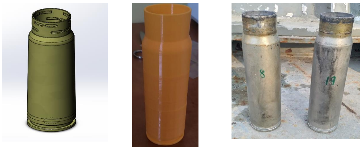
Fig. 10 (a), (b), (c) - Prezentarea tubului cartuș în diferite etape de dezvoltare
