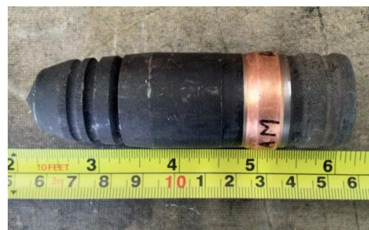
Fig. 8 (a), (b) - Brâul forțator în diferite etape ale dezvoltării constructive și funcționale
