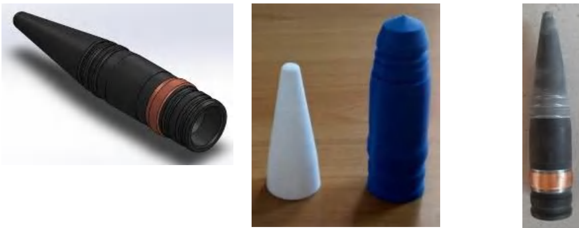
Fig. II.8 (a), (b), (c) - Prezentarea proiectilului asamblat
