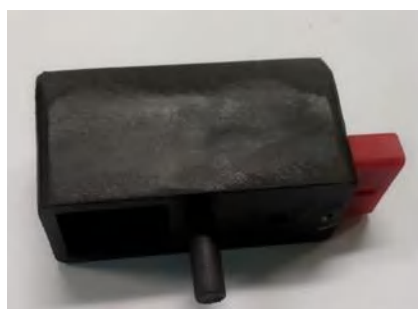
Fig. II.12.a- Piston ejector cu mecanismul de întârziere
