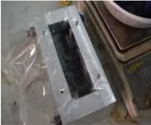
Fig. II.3.a -Căptușirea cu folie de PE și încărcarea matriței cu compoziție
