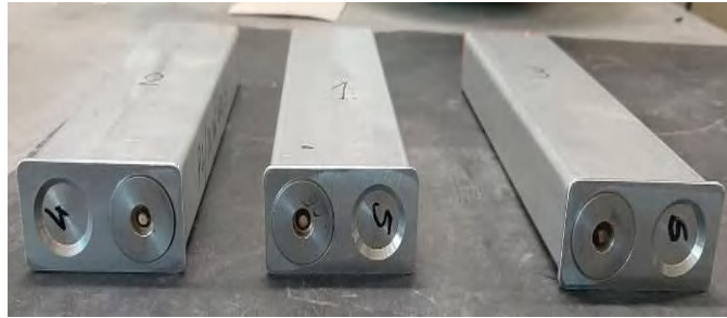
Fig.II.12.h - Muniție FLARE 2x1x8” echipată cu capsă de aprindere și evacuare calup pirotehnic
