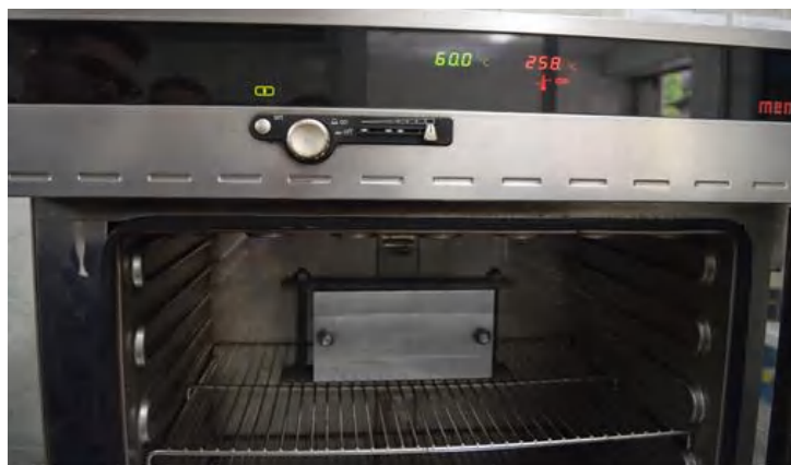
FigII.4.b -Menținerea matriței încărcate cu compoziție la 60°C
