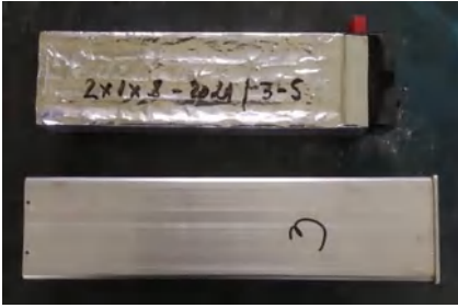
Fig.II.12.g - Calup pirotehnic 2x1x8” învelat în folie de aluminiu, prevăzut cu pistonul ejector
