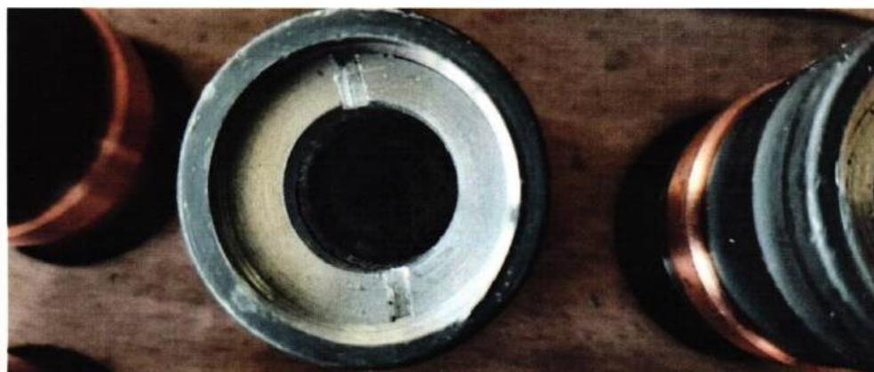
*Fig. 13 - Verificare asamblării corecte a trasorului*
