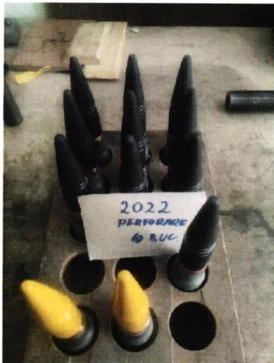
**Fig. 20 -** Lovituri pregătite pentru verificarea capacității de perforare
