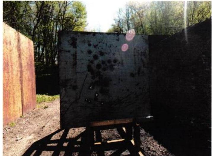
**Fig. 17** - *Verificarea capacităților de perforare*
