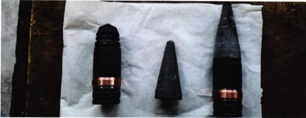
**Fig. 14 - Verificare proiectilului perforant trasor**
