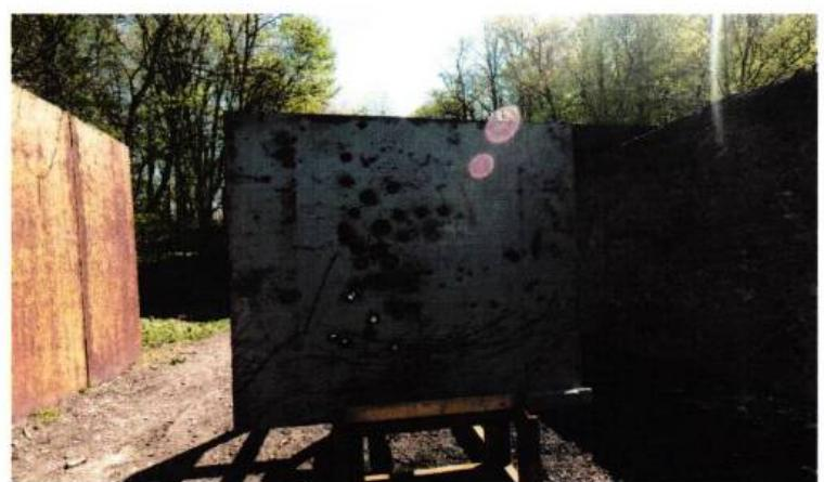
**Fig. III. 20 - Verificarea capacităților de perforare**
