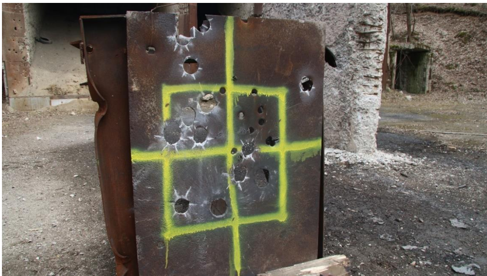
Fig. 10 – Perforarea unui oțel blindaj de către loviturile temperate
