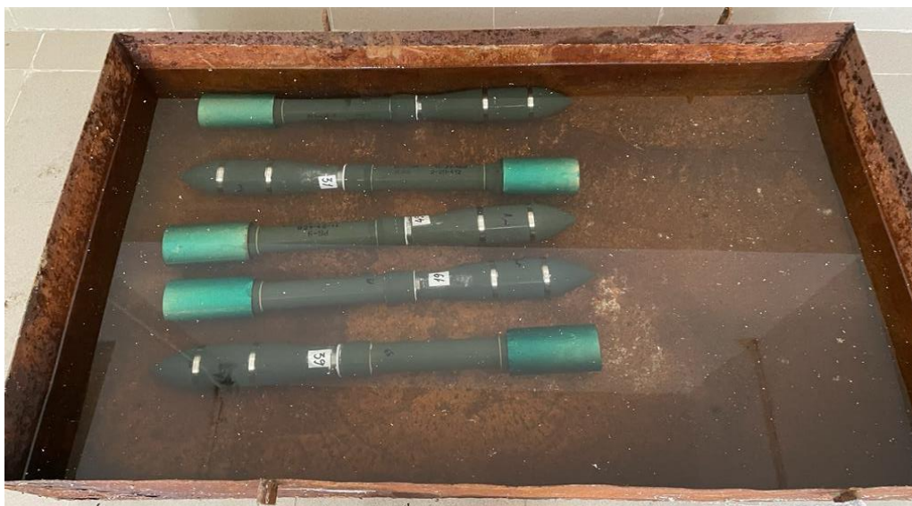
Fig. 8 – Lovitură perforant termobarică menținută în apă timp de 24h (5 buc)
