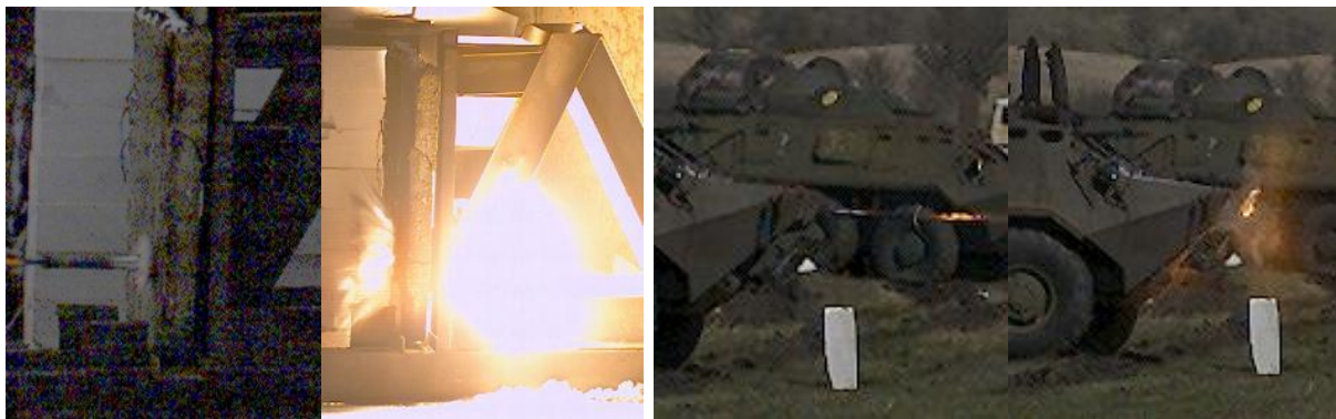
Fig.3 Determinarea capacității de penerare în beton armat și în blindaj
