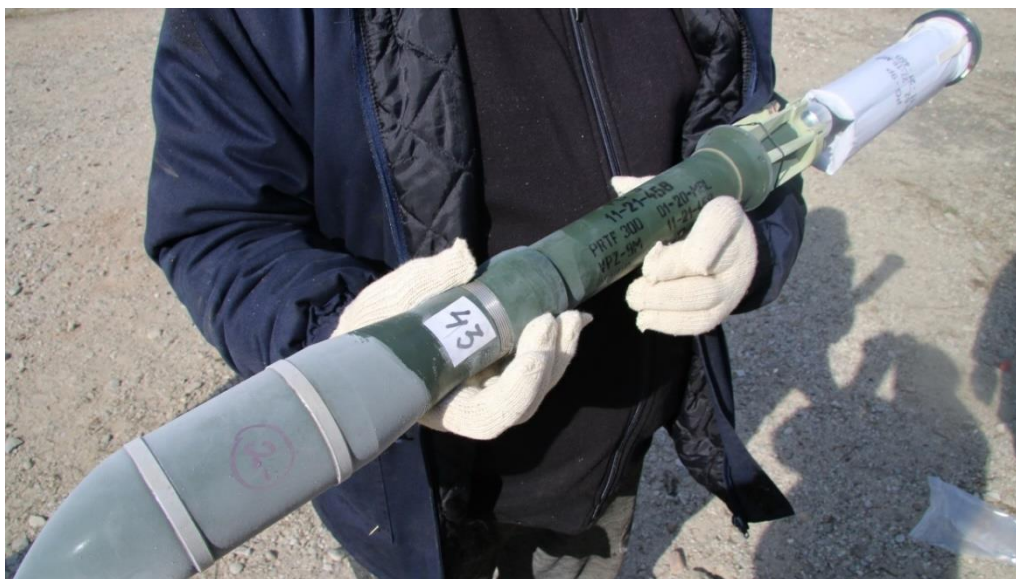
Fig. 9 – Lovitură perforant termobarică temperată la -32 °C
