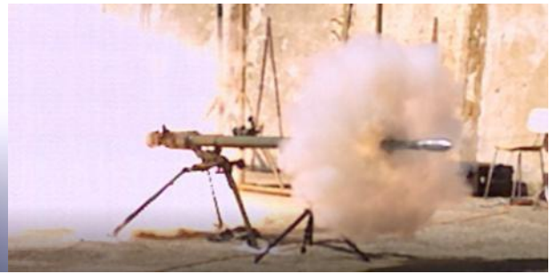
Fig.2. Lovitură perforant-termobarică pentru aruncătorul AG-9) - model experimental
