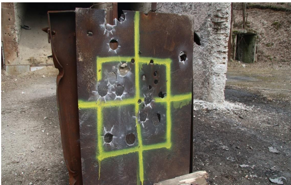
Fig. III.5 – Perforarea unui oțel blindaj de către loviturile temperate
