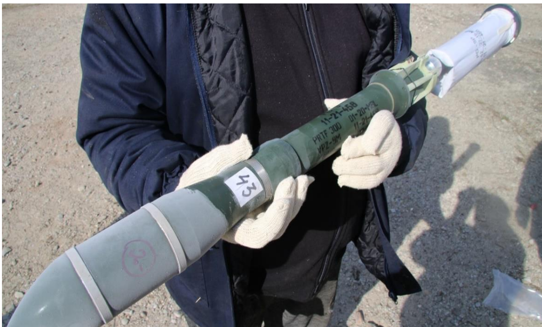
Fig. III.4 – Lovitură perforant termobarică temperată la -32^\circ\text{C}
