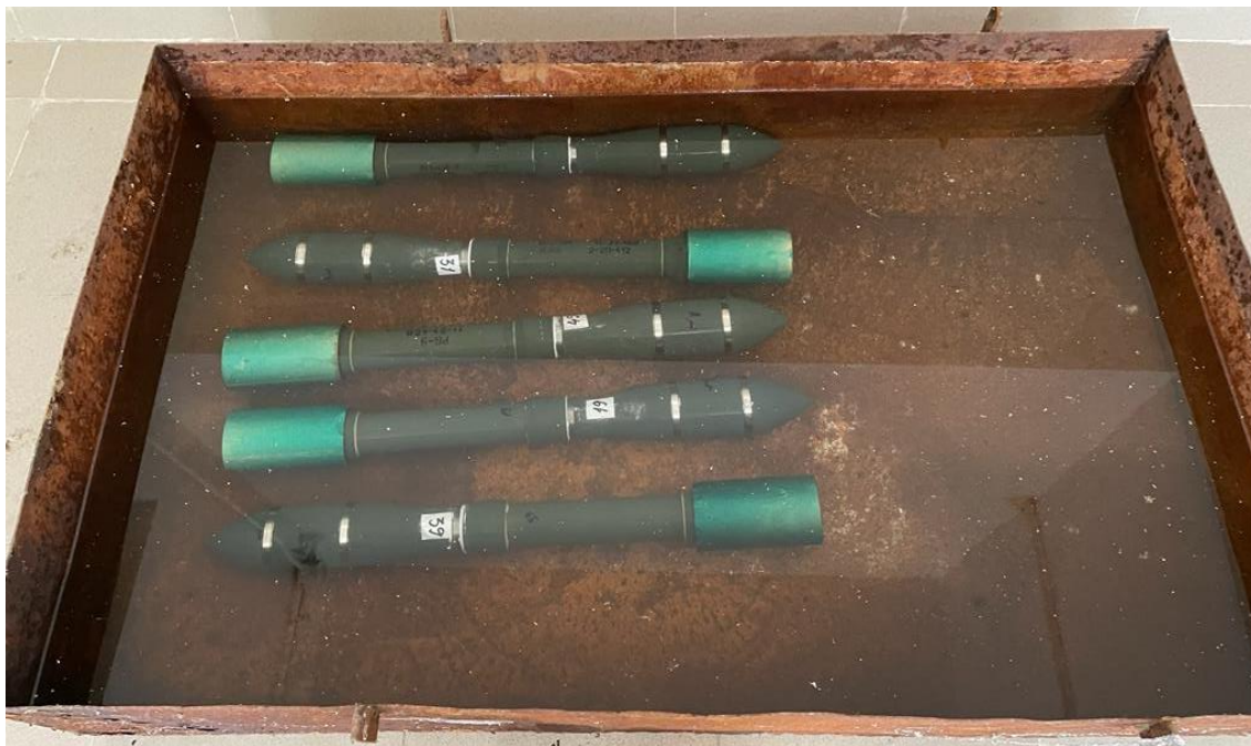
Fig. III.3 – Lovitură perforant termobarică menținută în apă timp de 24h (5 buc)
