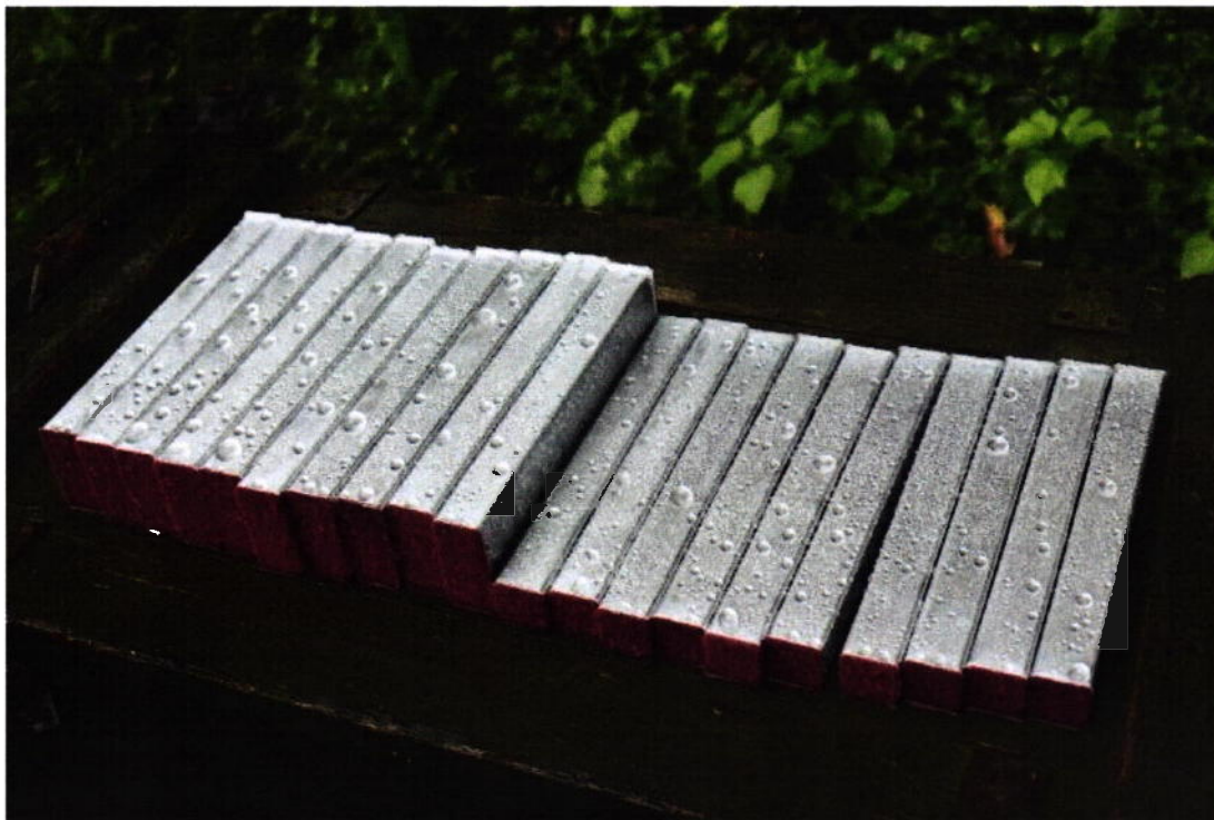
Fig.15 - Expunere muniție la precipitații ce simulează regimul dinamic de zbor
