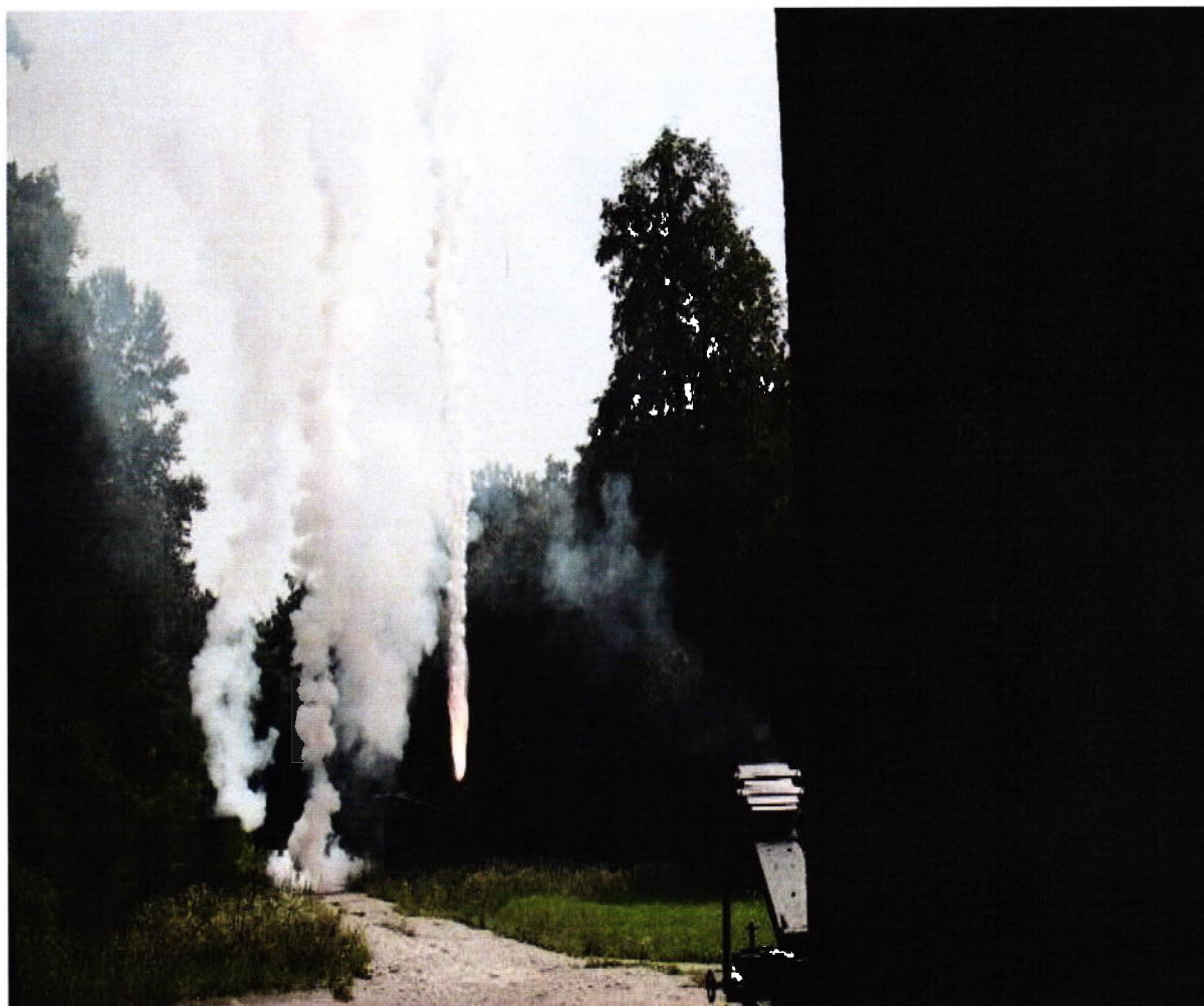
Fig.14 - Testare muniție F2 după inducerea unui șoc termic ( -46^{\circ}\text{C} / +71^{\circ}\text{C} )
