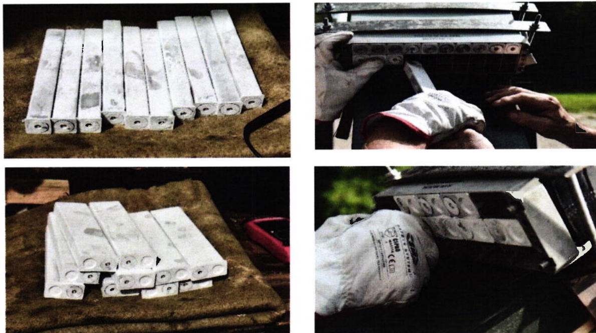
Fig.13 - Muniție F1, F2 după temperare la -46°C
