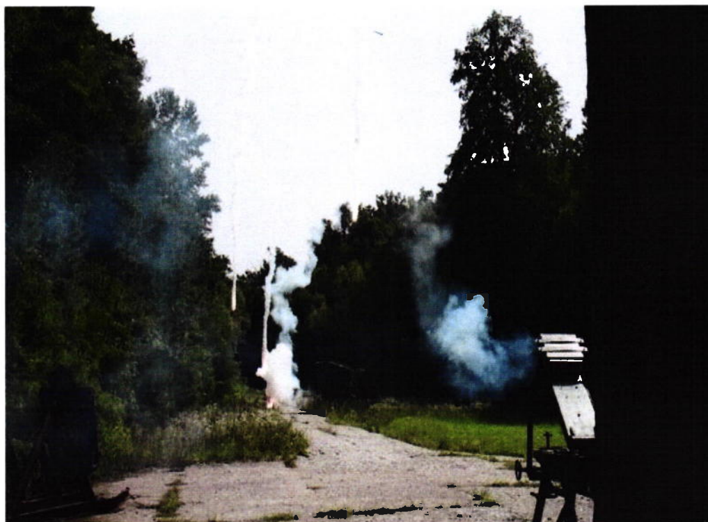
Fig.16 - Testare muniție F1 după imersarea în apă
