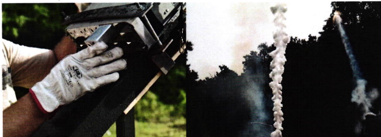
Fig.12 - Testare muniție după temperare la +71°C
