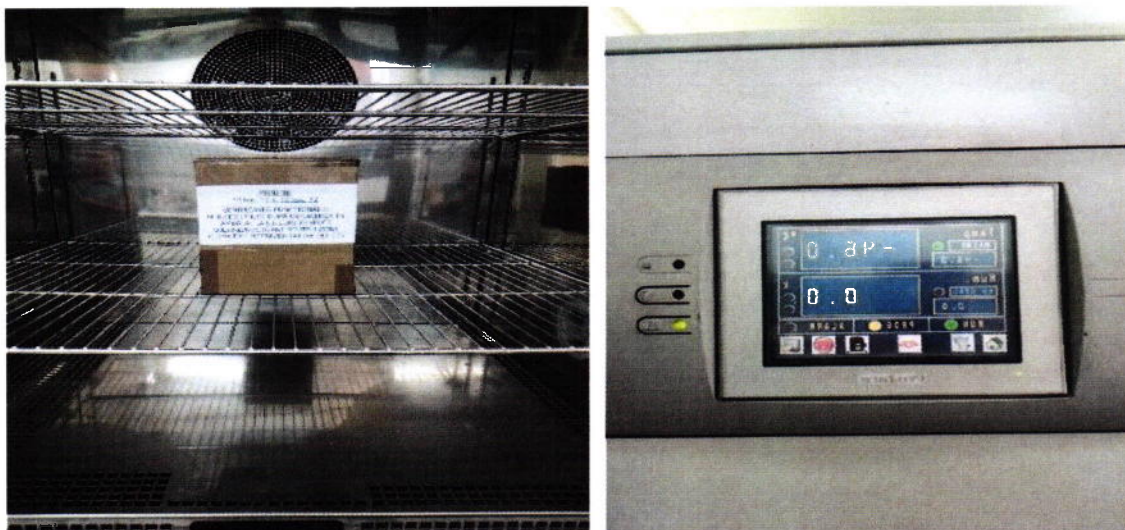
Fig.9 - Condiționare muniție în camera climatică
