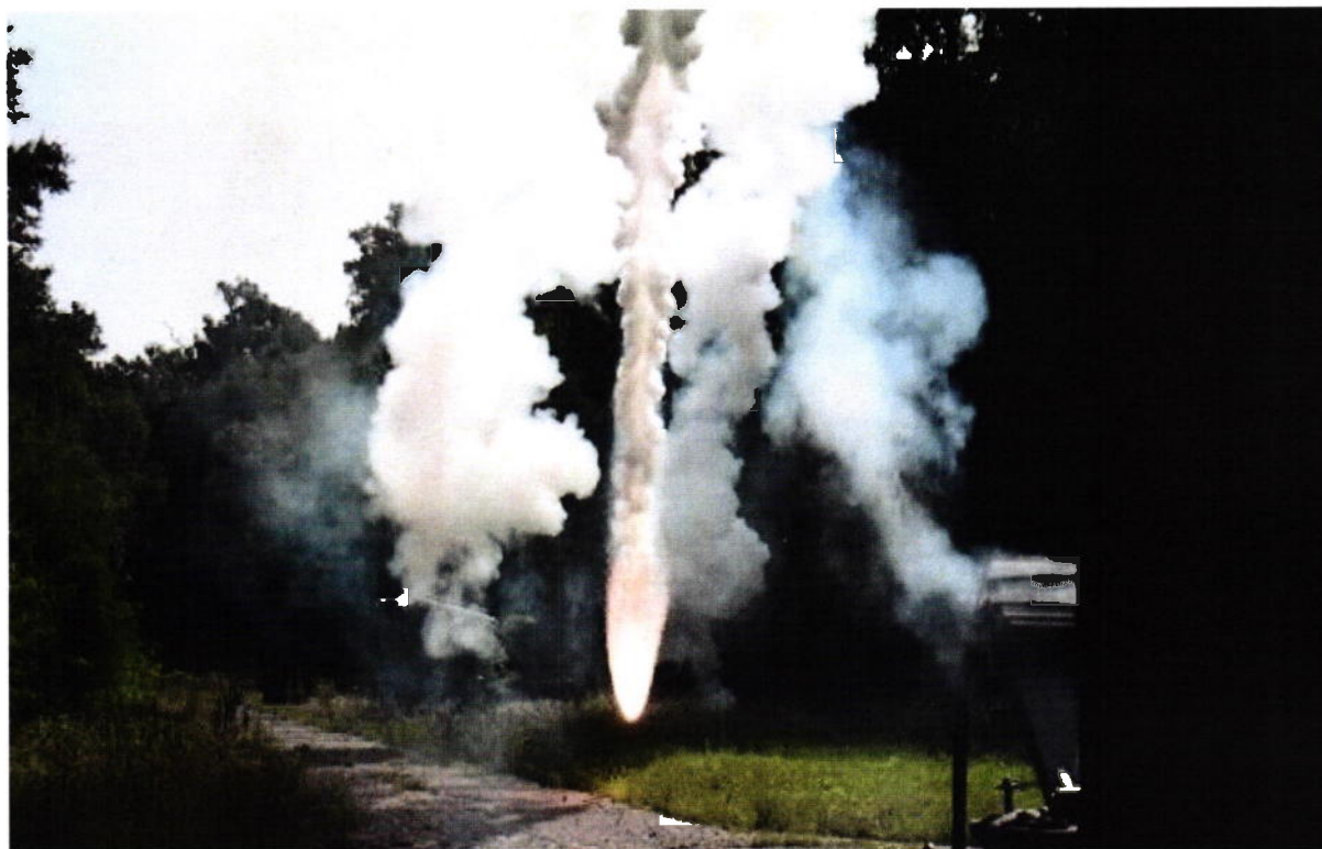
Fig.10 - Testare muniție după expunerea muniției la cicluri termice diurne/nocturne pentru zone climatice reprezentative (B3 –C2)
