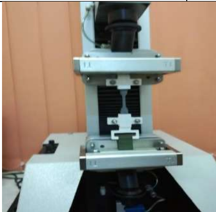
Figura 5-Modalitatea de prindere a epruvetelor de combustibil compozit între clemele aparatului de testare; înregistrare grafic date: extensia (mm) funcție de forța (N)
