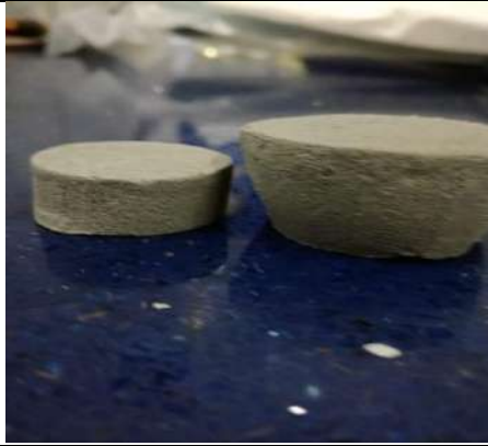
Figura 3. Discuri de combustibil compozit pregătite pentru testul de măsurare a densității reticulare: înainte și după gonflare
