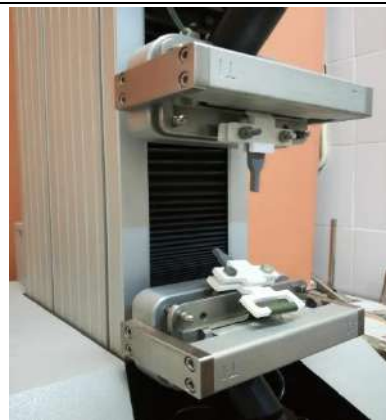
Figura 5-Modalitatea de prindere a epruvetelor de combustibil compozit între clemele aparatului de testare; înregistrare grafic date: extensia (mm) funcție de forța (N)
