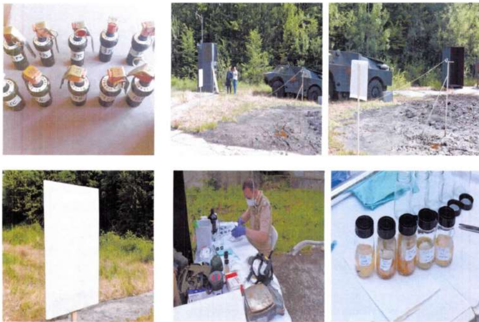
Figura 2. Verificarea funcționării corespunzătoare a muniției iritant – lacrimogene: amplasarea țărurilor cu plăcile acoperite cu hârtie absorbantă, amplasarea muniției iritant-lacrimogene; prepararea probelor de hârtie absorbantă în vederea analizelor gaz – cromatografice
