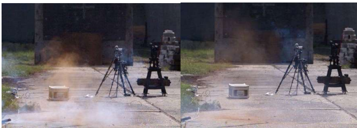
Figura 4c - Aerosolizarea prin explozie și amestecare turbulentă cu aerul
