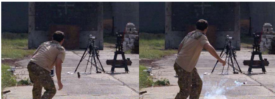
Figura 4a - Aruncarea grenadei și detașarea capului focosului
