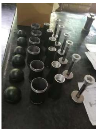
Figura 9 - Repere metalice ale corpului grenadei
