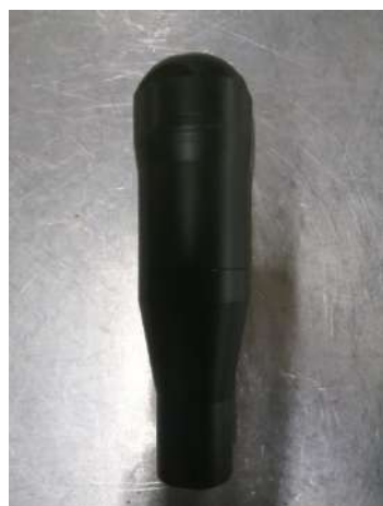
Figura 11 - Grenadă EFP/TB asamblată
