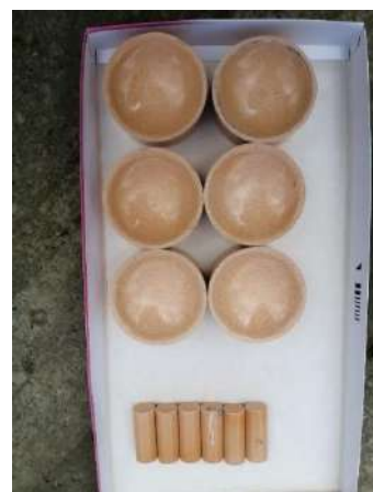
Figura 13 - Calupi explozivi pentru teaca centrală și paharul EFP-ului
